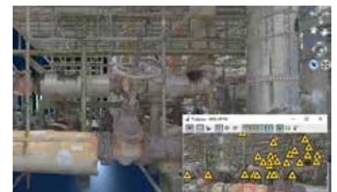
Punktwolke eines Anlagenteils, der kleine Ausschnitt zeigt in Gelb die Scanpunkte in der Anlage
