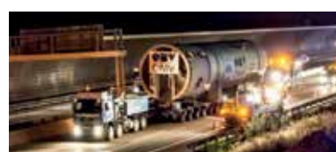
High & Heavy: Transport des 25 m hohen und 382 t schweren Reaktors über die A4 bei Wien. Die Strecke betrug 14 km, die in fünf Stunden bewältigt wurde. Die Planung dazu dauerte über 24 Monate.
