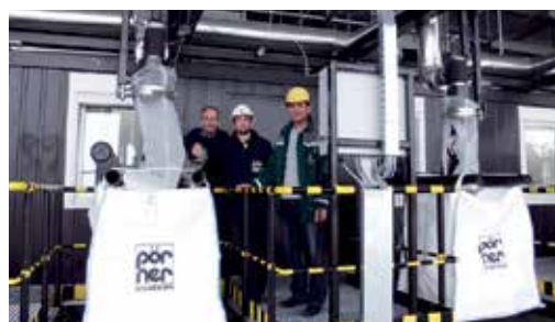
2. Установка охлаждения и затаривания битума «Пернер»
