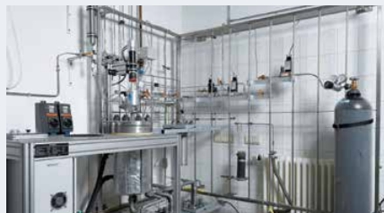
Опытная установка SDA оснащена автоклавами для сверхкритических и подкритических условий
