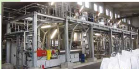
Planung und Errichtung einer Anlage zur Produktion von 4.000 TPA vollsynthetischer Wachse aus Polyethylen und Polypropylen mittels Depolymerisation; Webau / Deutschland, 2016
