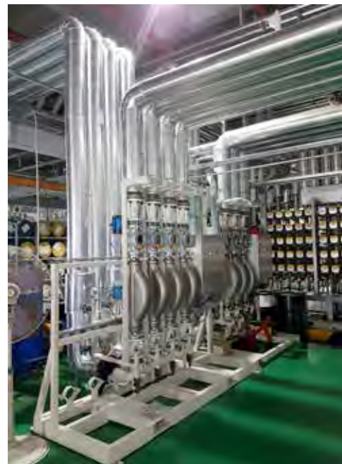
Блендер с одновременным дозированием (SMB), поставленный EDL: на заднем плане - SMB 2015 года, впереди - расширение на 4 линии в 2019 году.
