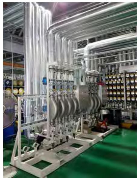
Simultaneous Metering Blender (SMB), geliefert durch EDL: im Hintergrund der SMB von 2015, im Vordergrund die Erweiterung um vier Linien von 2019
